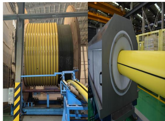
重点研发产品： 深水油气高性能动态柔性立管
