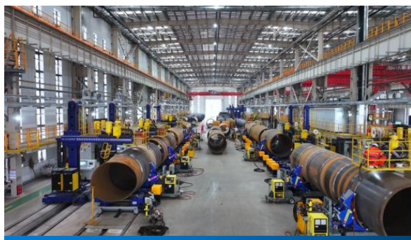
结构制管智能生产线成果已在多个工程项目应用，助力工效从2.544工日/吨提升至1.892工日/吨，工效提升25.63%
