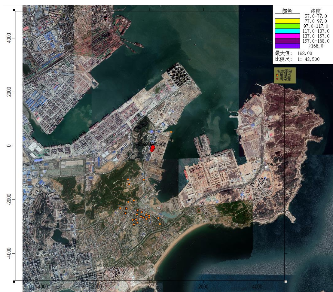
图 6.1-7 叠加现状后对区域各网格点处 NMHC 小时平均质量浓度分布图（单位： \mu\text{g}/\text{m}^3 ）
