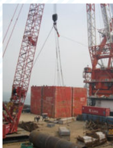
主吊机负载试验 Load test for main crane
